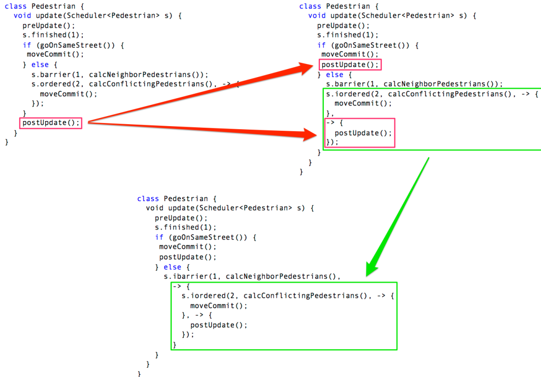
図 8 非同期なグループバリアを用いるためのスレッド分割
