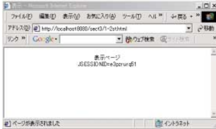
図 2.4: cookie に格納していたセッション ID がブラウザ上に表示された様子
